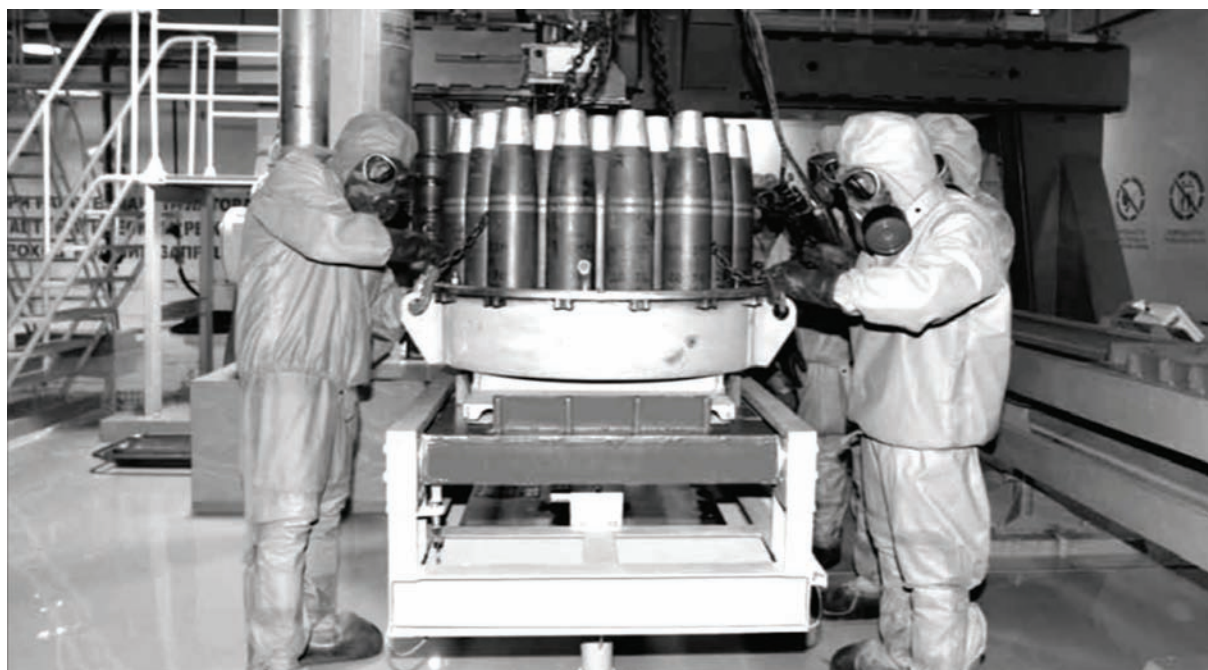
Рис. 1. Химические боеприпасы на автоматизированной поточной линии по их уничтожению [5].
