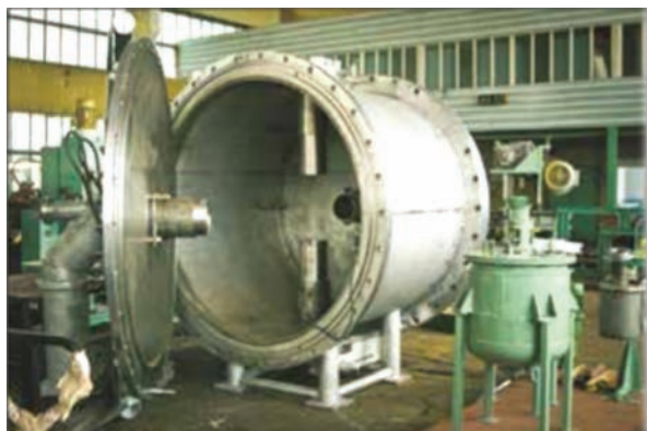
Рис. 2. Экспериментальный комплекс обезвреживания изделий сложной конструкции [цит. по 8].
