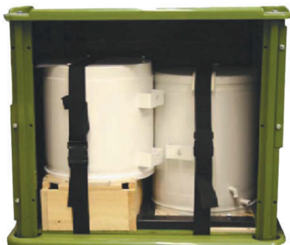
Рис. 3. Размещение дистиллятора в ЯМУ.
