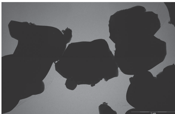
Размер частиц смешанного оксида урана U_3O_8 (1 мкг = 0,59 pCi) для интратрахеального введения. Электронная микрофотография частиц.
